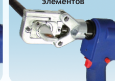
прессовка соединительных элементов
